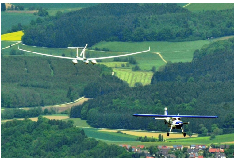
Bildunterschrift: Vogelzug der besonderen Art: Die Antares DH-2 am 30m langen Schleppseil hinter der Do27, beim Anflug auf Oberpfaffenhofen
